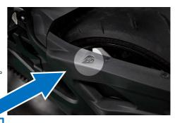
SUZUKI Parts No. 09139-06221 · · · Screw Front Fender
