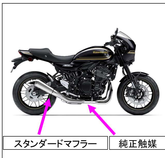
製品と純正触媒の取付写真
