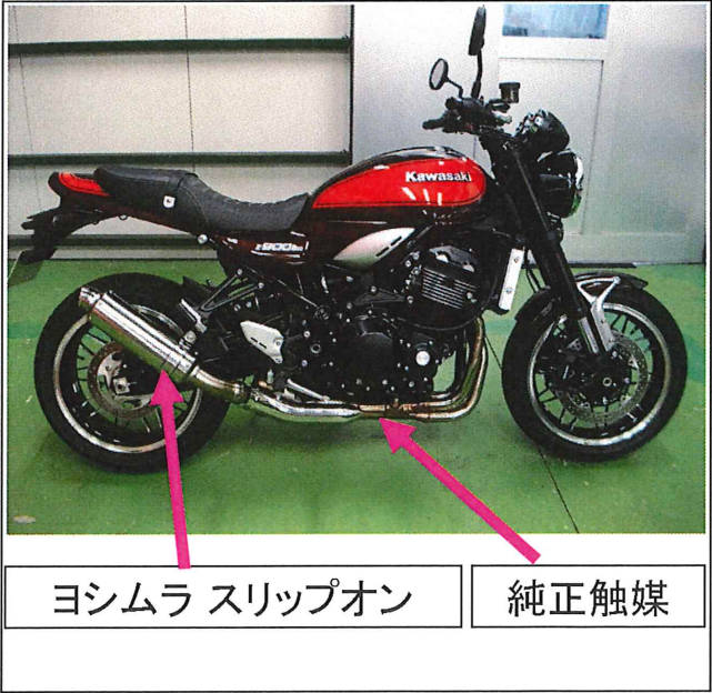
製品と純正触媒の取付写真
