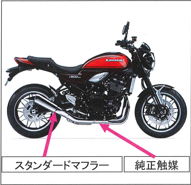
製品と純正触媒の取付写真
