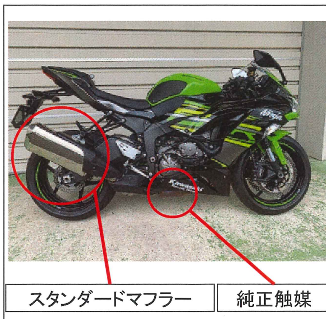
製品と純正触媒の取付写真
