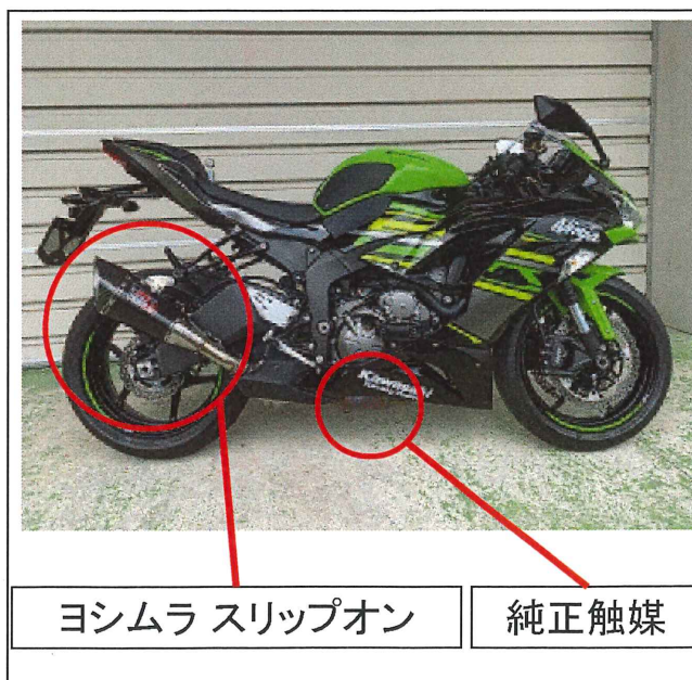
製品と純正触媒の取付写真
