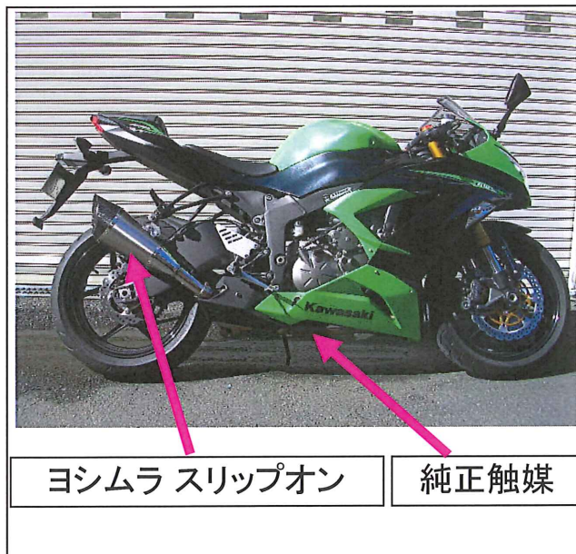
製品と純正触媒の取付写真
