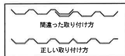
図1 オイルリングエキスパンダー 取り付け図
